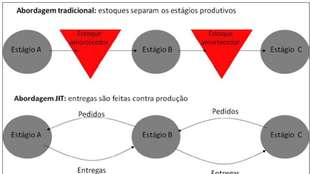
FIGURA 14 – COMPARATIVO DO FLUXO PRODUTIVO TRADICIONAL (JIC) COM O JIT
