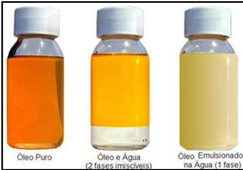
FIGURA 31 - COMPARAÇÃO ENTRE TRÊS FRASCOS CONTENDO ÓLEO PURO (UMA FASE), ÁGUA E ÓLEO (DUAS FASES) E NO ÚLTIMO FRASCO TEMOS ÓLEO E ÁGUA ADICIONADOS DE AGENTE EMULSIONANTE
