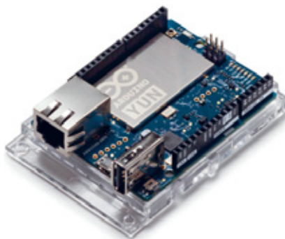
FIGURA 7 – ARDUINO YUN, PLACA QUE JÁ VEM COM SUPORTE NATIVO PARA REDE CABEADA (RJ45) E REDE WIRELESS
