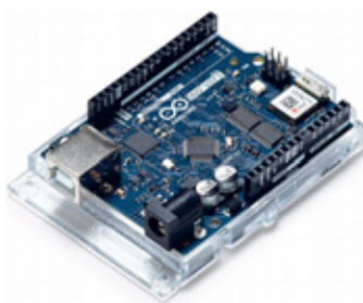
FIGURA 5 – ARDUINO UNO Wi-Fi REV.2. ESTE ARDUINO JÁ VEM EQUIPADO COM OS CIRCUITOS NECESSÁRIOS PARA A COMUNIDADE Wi-Fi
