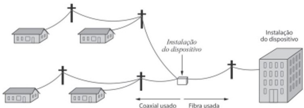
FIGURA 12 – SISTEMA DE ACESSO HYBRID FIBER COAX
