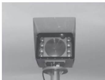
FIGURA 20 – ENLACE PONTO A PONTO UTILIZANDO TECNOLOGIA A LASER
