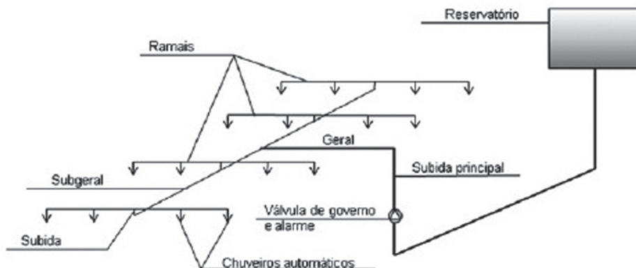
Figura 8 - Componentes de Rede de Sprinklers
